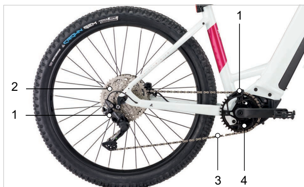
Abbildung 27: Schema Kettenantrieb mit Kettenschaltung
