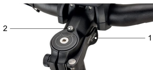
Abbildung 59: Vorbau, Ausführung II mit Spannhebel des Vorbau-Schnellspanners (1) und Entsperrknopf (2)
