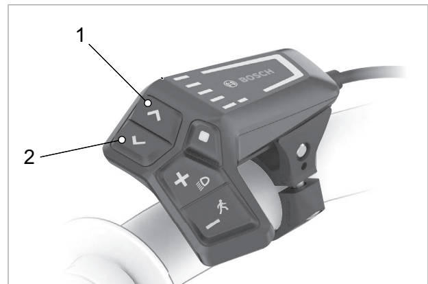
Abbildung 163: Lage Helligkeit erhöhen-Taste (2) und Helligkeit vermindern-Taste (1)
