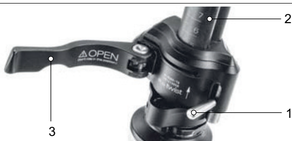
Abbildung 58: Geöffneter Spannhebel des Vorbau-Schnellspanners (3) am Vorbau (2), Ausführung I, mit Sicherungshebel am Vorbau (1)
