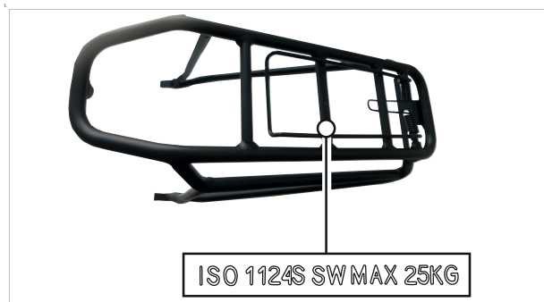
Abbildung 153: Auf dem Gepäckträger ist seine maximale Tragfähigkeit (1) ausgewiesen
