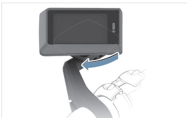
Abbildung 117: Bildschirm im Uhrzeigersinn drehen
