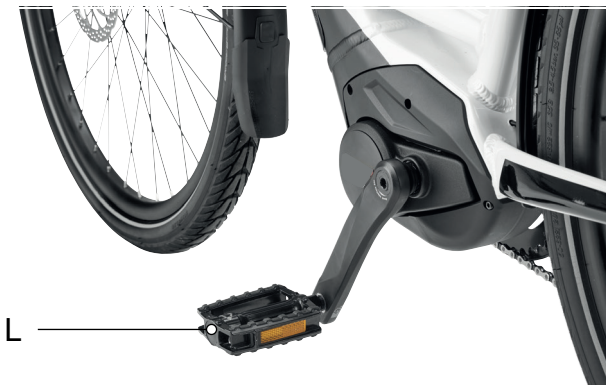
Abbildung 61: L Pedal im linken Kurbelarm
