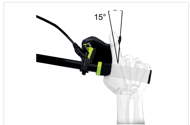
Abbildung 103: Position der Handbremse
