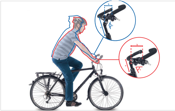
Abbildung 82: Citybike (blau) und Trekkingrad Position (rot) durch Winkeländerung
