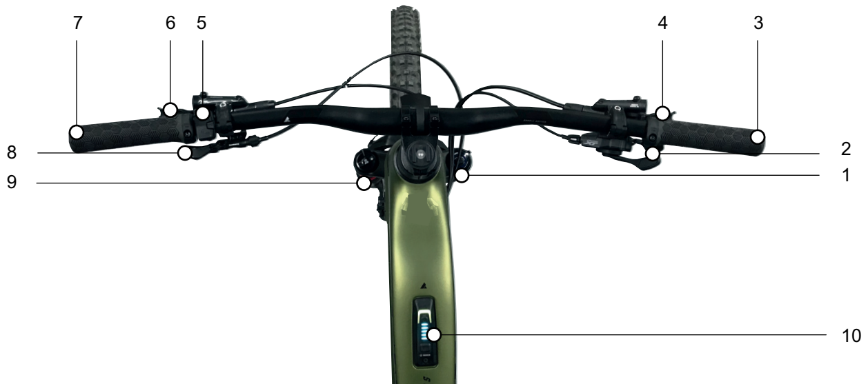
Abbildung 40: Detailansicht Lenker mit Bordcomputer BOSCH System Controller und Bedieneinheit Mini Remote, Beispiel
