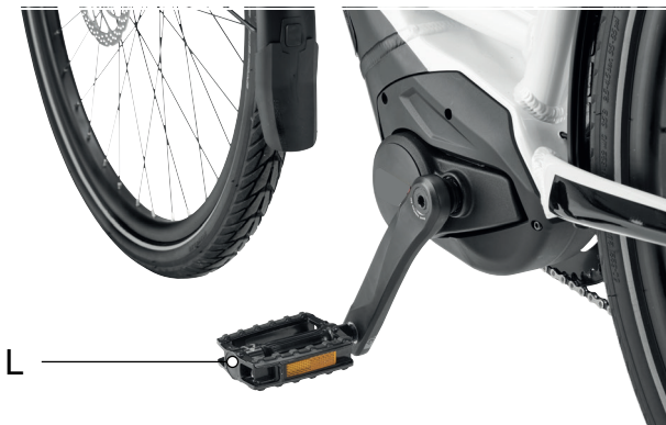
Abbildung 67: L Pedal im linken Kurbelarm
