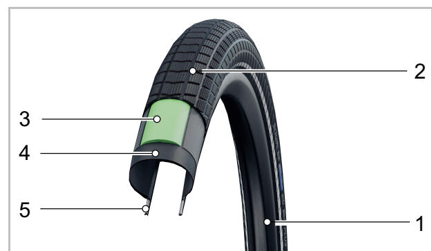
Abbildung 11: Aufbau offener Reifen
