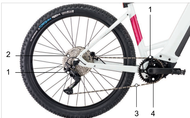
Abbildung 33: Schema Kettenantrieb mit Kettenschaltung
