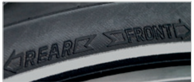
Abbildung 62: Laufrichtungspfeil auf MTB-Reifen
