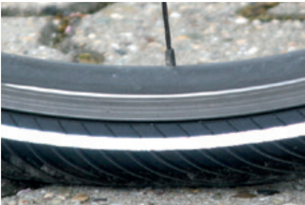
Abbildung 84: Korrekter Fülldruck. Der Reifen ist unter der Last des Körpergewichts kaum verformt
