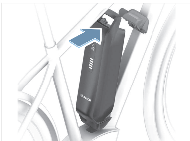
Abbildung 149: PowerPack Akku nach oben klappen
