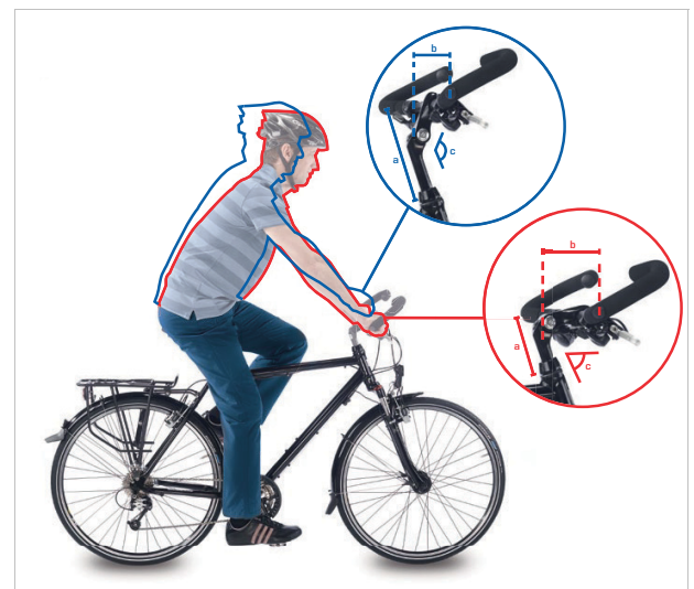
Abbildung 105: Citybike (blau) und Trekkingrad Position (rot) durch Winkeländerung
