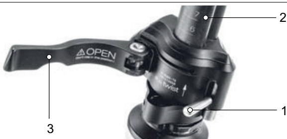
Abbildung 64: Geöffneter Spannhebel des Vorbau-Schnellspanners (3) am Vorbau (2), Ausführung I, mit Sicherungshebel am Vorbau (1)
