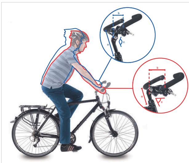
Figura 84: Posición de la bicicleta de ciudad (azul) y la bicicleta de trekking (rojo) mediante la modificación angular
