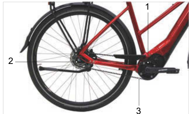
Figura 30: Esquema de la transmisión por correa
