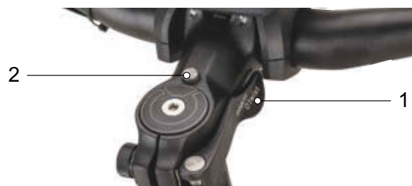
Figura 58: Potencia, versión II con palanca tensora del cierre rápido de la potencia (1) y botón de desbloqueo (2)
