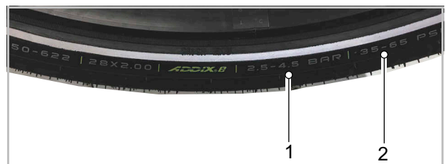
Figura 133: Indicación de presión de inflado en bar (1) y psi (2)
