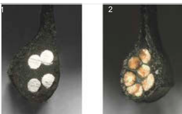
Figura 12: Núcleo de acero (1) y núcleo de Kevlar (2)
