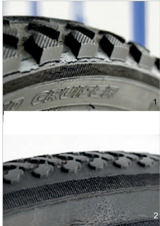
Abbildung 140: Beispiele für Ermüdungsrisse (1) und Alterungsrisse (2)
