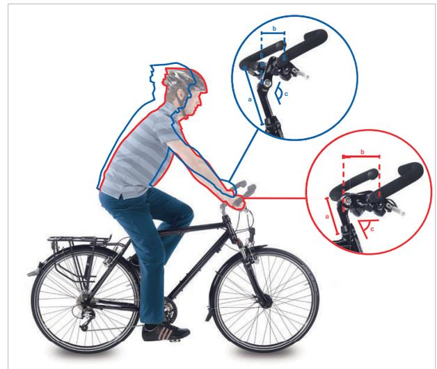
Abbildung 85: Citybike (blau) und Trekkingrad Position (rot) durch Winkeländerung
