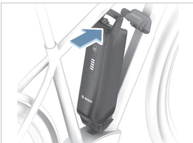
Abbildung 113: PowerPack Akku nach oben klappen
