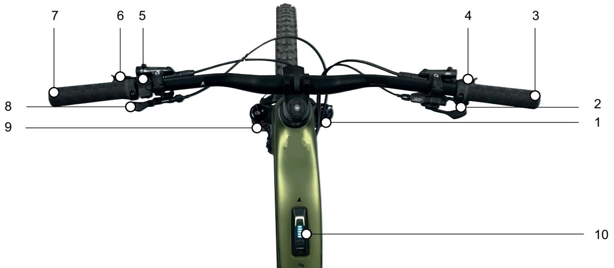
Abbildung 38: Detailansicht Lenker mit Bordcomputer BOSCH System Controller und Bedieneinheit Mini Remote, Beispiel
