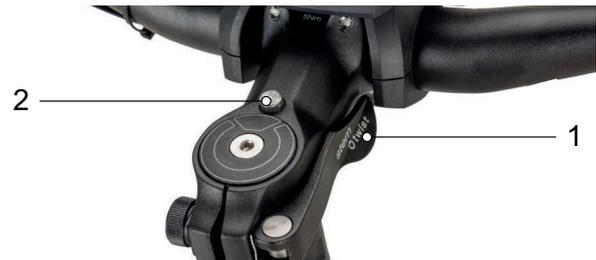
Abbildung 60: Vorbau, Ausführung II mit Spannhebel des Vorbau-Schnellspanners (1) und Entsperrknopf (2)
