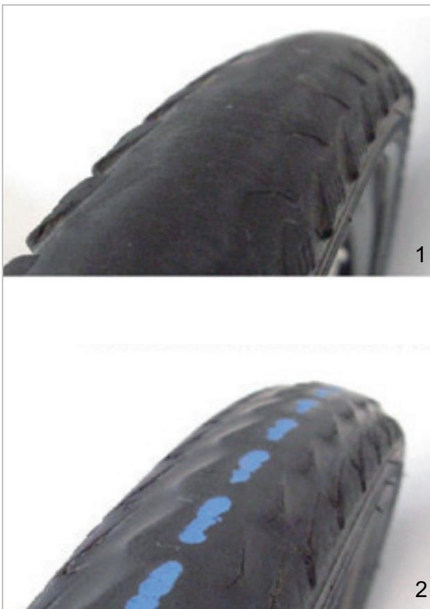
Abbildung 139: Reifen ohne Profil, der gewechselt werden kann (1) und Reifen mit durchscheinendem Pannenschutz (2), der gewechselt werden muss
