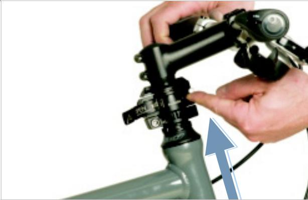
Abbildung 114: Entriegelungsbolzen nach oben drücken
