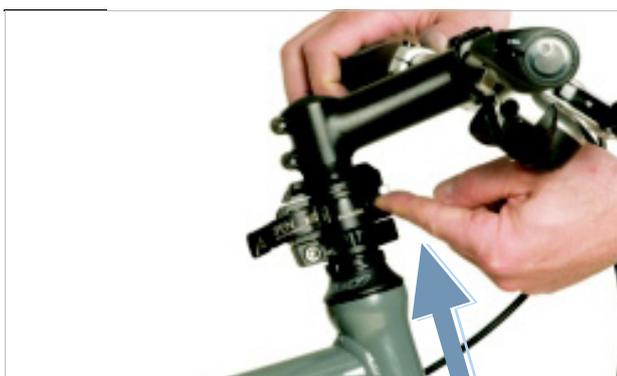
Abbildung 132: Entriegelungsbolzen nach oben drücken
