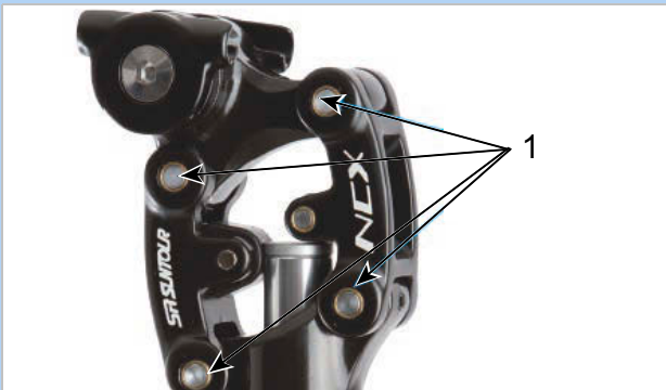
Illustration 174 : Points de lubrification de la tige de selle suspendue SR SUNTOUR
