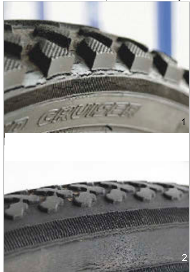
Illustration 143 : Exemples de fissures de fatigue (1) et de fissures d'âge (2)
