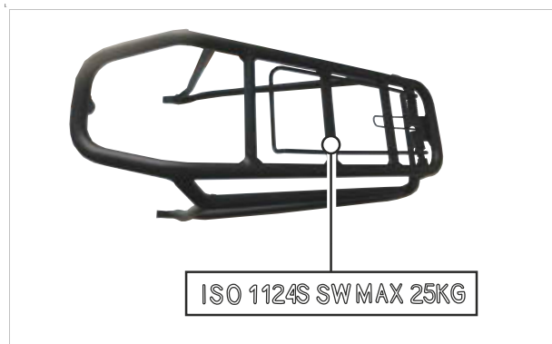
Illustration 117 : La capacité de charge maximale (1) est indiquée sur le porte-bagages.
