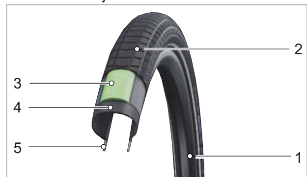
Illustration 12 : Structure des pneus ouverts
