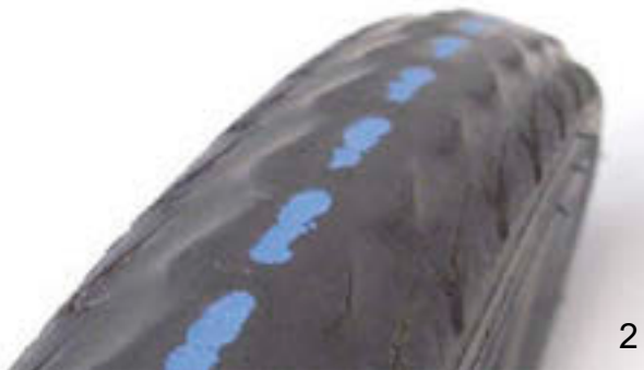
141. ábra: Profil nélküli gumiabroncs, amelyet cserélni lehet (1), és gumiabroncs áttetsző defektvédelemmel (2), amelyet cserélni kell
