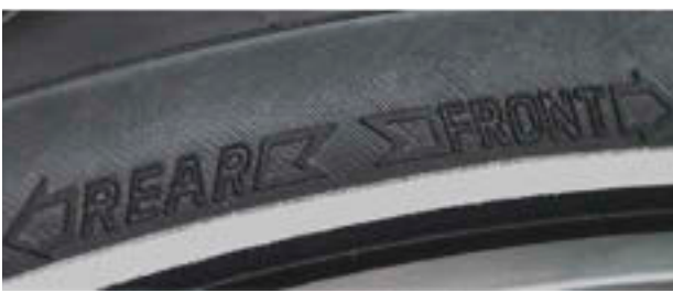
47. ábra: Futásirányjelző nyíl MTB gumiabroncsokon
