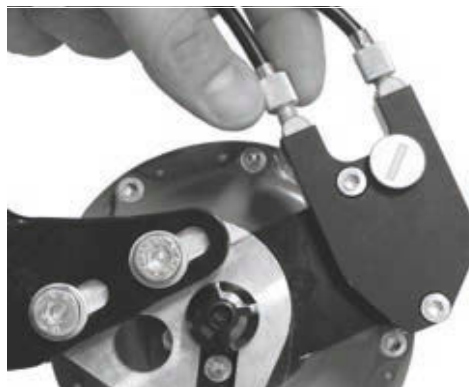
158. ábra: Külső váltóvezérléssel rendelkező ROHLOFF agyváltózatok húzásbeállítója a kötéldobozon van, ami a bal oldalon található
