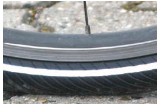
79. ábra: Helyes töltőnyomás. A gumiabroncs alakja a testsúly terhe alatt alig változik
