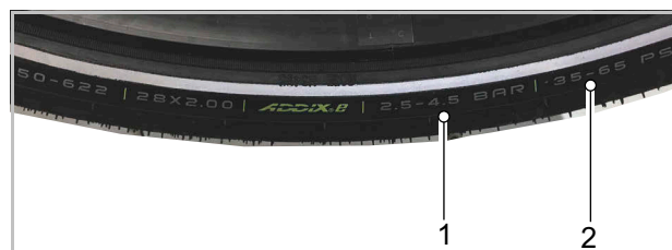
122. ábra: Guminyomás bar-ban (1) és psi-ben (2)
