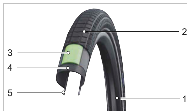
11. ábra: Nyitott gumiabroncsok felépítése
