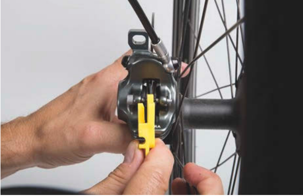
Illustration 143 : Contrôler la plaquette de frein montée à l'aide de la cale de transport
