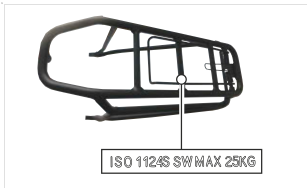
Illustration 107 : La capacité de charge maximale (1) est indiquée sur le porte-bagages.
