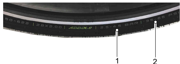
Illustration 140 : Indication de pression des pneus en bar (1) et psi (2)
