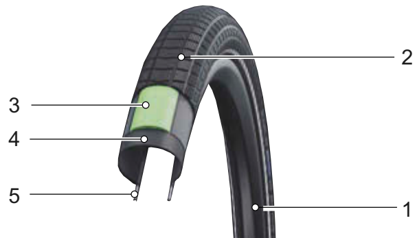
Illustration 11 : Structure des pneus ouverts
