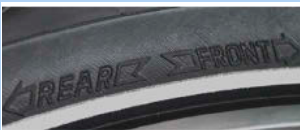
Illustration 47 : Flèche directionnelle sur les pneus VTT
