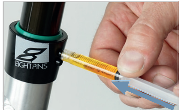
Abbildung 137: EIGHTPINNS Sattelstütze schmieren
