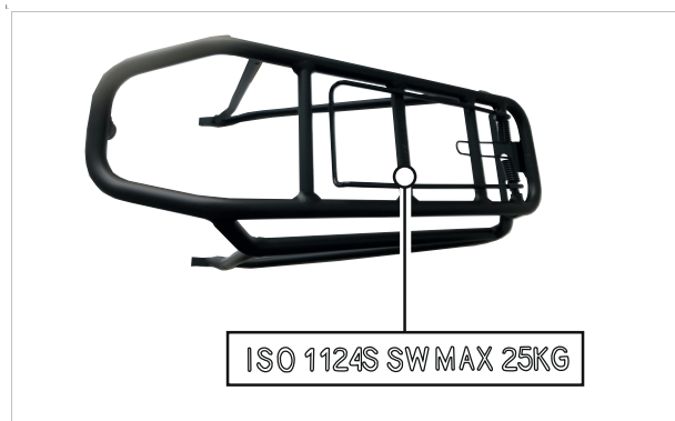
Abbildung 118: Auf dem Gepäckträger ist seine maximale Tragfähigkeit (1) ausgewiesen.
