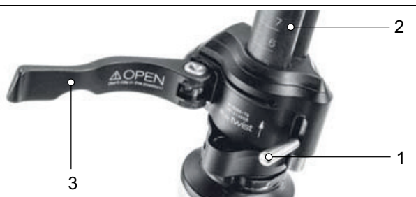
Abbildung 59: Geöffneter Spannhebel des Vorbau-Schnellspanners (3) am Vorbau (2), Ausführung I, mit Sicherungshebel am Vorbau (1)
