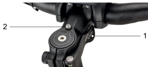
Abbildung 60: Vorbau, Ausführung II mit Spannhebel des Vorbau-Schnellspanners (1) und Entsperrknopf (2)
