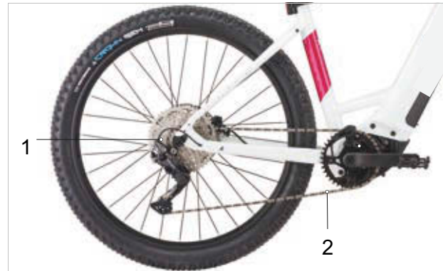
Afbeelding 29: Schema kettingaandrijving met derailleur
