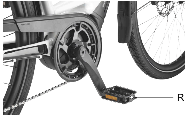
Afbeelding 61: R-pedaal in de rechter crankarm
