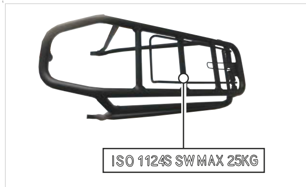
Afbeelding 117: Op de bagagedrager staat het maximale draagvermogen (1) vermeld
