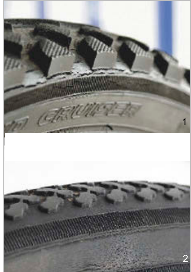
Afbeelding 135: Voorbeelden van vermoeiingsscheuren (1) en verouderingsscheuren (2)
