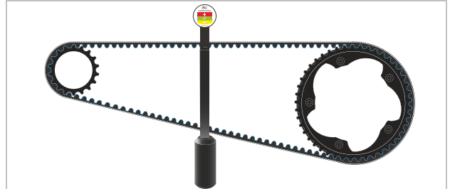
Figura 149: Varilla de medición enganchada
