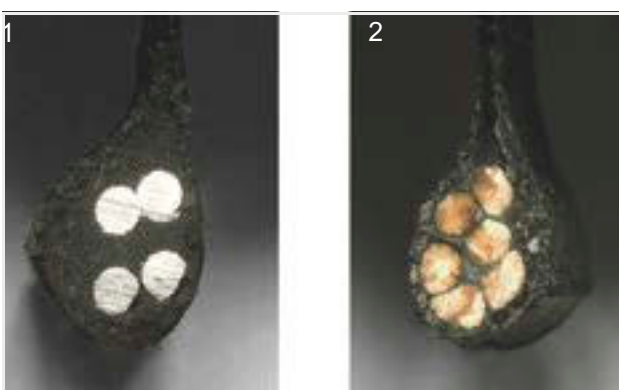
Figura 13: Núcleo de acero (1) y núcleo de Kevlar (2)
