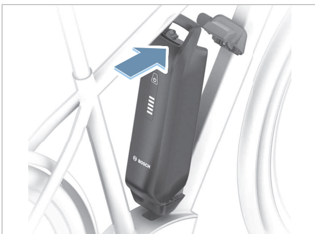
Abbildung 122: PowerPack Akku nach oben klappen
