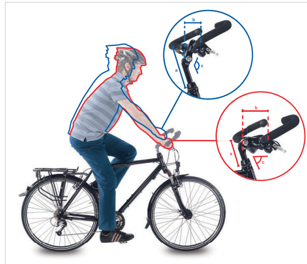
Abbildung 79: Citybike (blau) und Trekkingrad Position (rot) durch Winkeländerung
