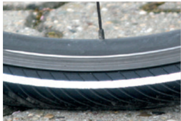
Abbildung 81: Korrekter Fülldruck. Der Reifen ist unter der Last des Körpergewichts kaum verformt.
