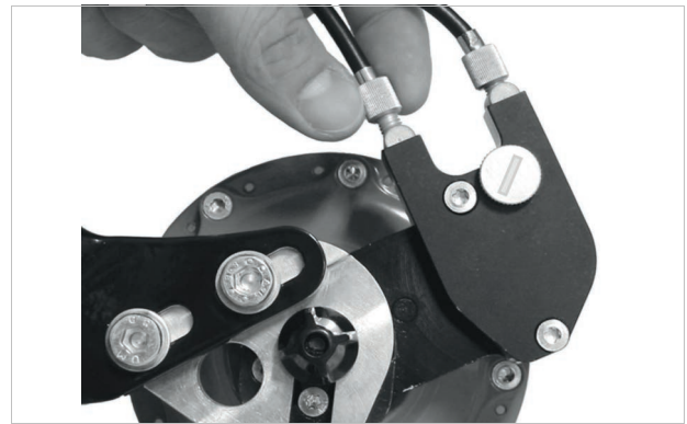
Abbildung 169: ROHLOFF-Naben Versionen mit externer Schaltansteuerung haben die Zugeinsteller an der Seilbox, die sich auf der linken Seite befindet
