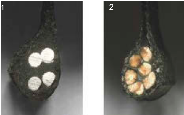
Figura 13: Núcleo de acero (1) y núcleo de Kevlar (2)
