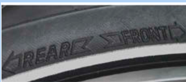
Figura 67: Flecha de sentido de la marcha en cubiertas de MTB
