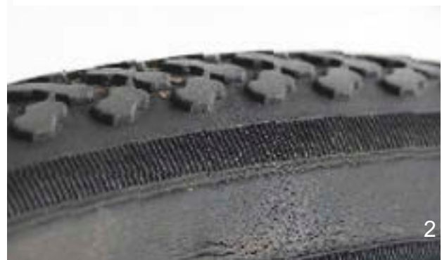
Figura 162: Ejemplos de fisuras por fatiga (1) y fisuras por envejecimiento (2)
