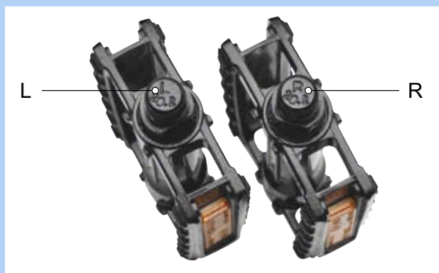
Figura 68: Ejemplo de marca de los pedales
