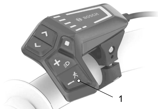
Figura 141: Posición del botón de ayuda para el desplazamiento (1)
