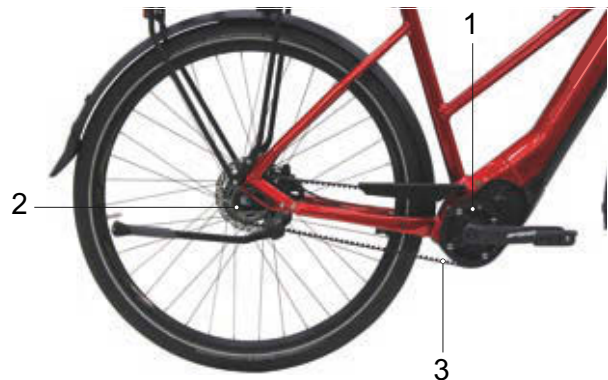
Figura 33: Esquema de la transmisión por correa
