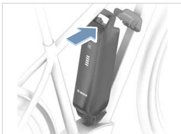
Figura 136: Plegado hacia arriba de la batería PowerPack
