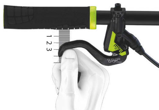
Figura 100: Posicionamiento del freno de mano
