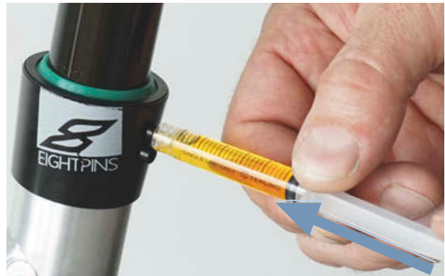
Figura 159: Lubricación de la tija de sillín eightpins
