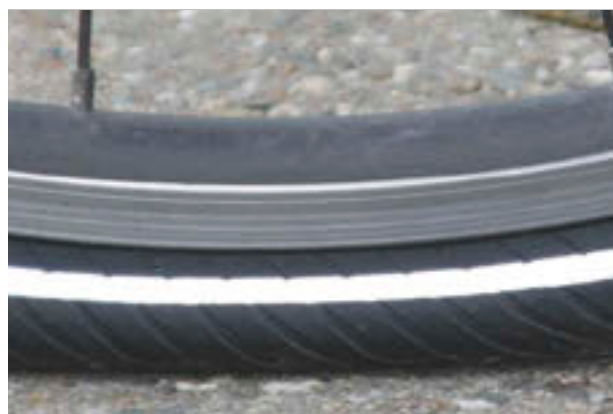
Figura 96: Presión de inflado demasiado baja
