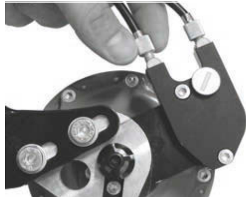
Figura 188: Las versiones de bujes ROHLOFF con activación de cambio externa tienen los dispositivos de ajuste de tensión en la caja de cables que se encuentra en el lado izquierdo
