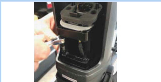
Figura 53: Retirada de los tornillos hexagonales de 4 mm
