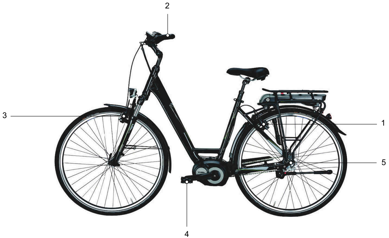
Figura 30: Sistema de frenado con un freno de contrapedal, ejemplo
