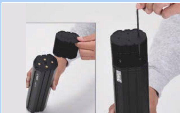
Figura 62: Montaje de la prolongación de la PowerTube
