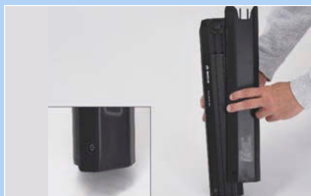
Figura 64: Desplazamiento de la cubierta de la batería sobre la batería
