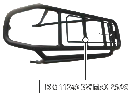
Figura 131: En el portaequipajes se indica la capacidad máxima de carga (1)
