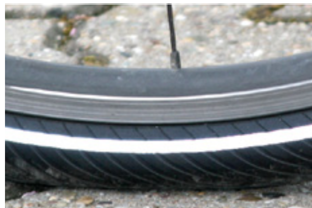
57. ábra: Helyes töltőnyomás. A gumiabroncs alakja a testsúly terhe alatt alig változik
