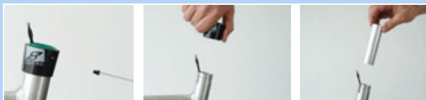
140. ábra: Külső hüvely és siklópersely kiszérése
