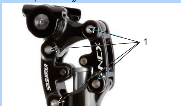
97. ábra: SR kenőpontok Suntour rugós nyeregcső
