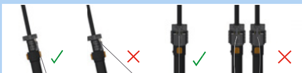
125. ábra: Helyesen és hibásan beállított bovdent
