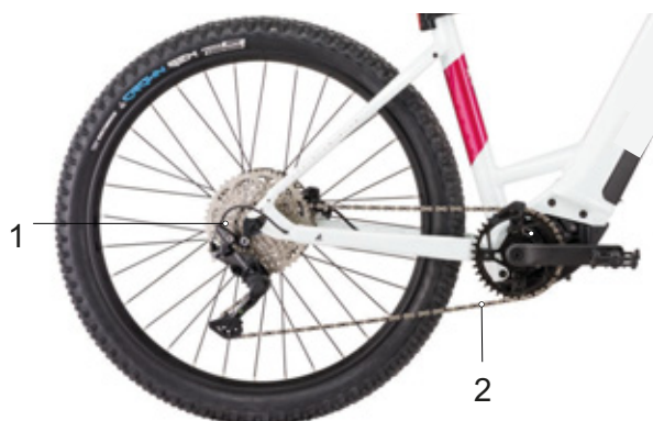
19. ábra: Külső váltóval felszerelt lánchajtás vázlata
