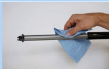
151. ábra: Hosszirányú vezetőhorny tisztítása
