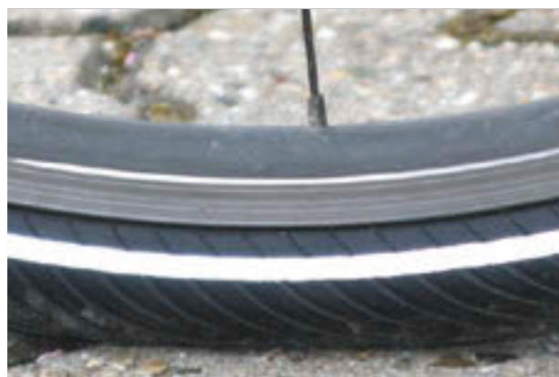
Figur 86: Korrekt dæktryk. Dækkets form er næsten ikke ændret af kropsvægtens belastning
