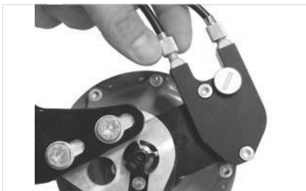
Figur 151: På udgaver af ROHLOFF-nav med ekstern skifteaktivering sidder kabelindstilleren på wireboksen, som sidder på venstre side
