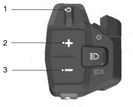
Figur 100: Navigations-vippetasten (1), Plus-tastens (2) og Minus-tastens (3) placering I
