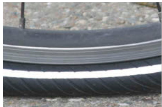
86. ábra: Túlontúl alacsony töltőnyomás
