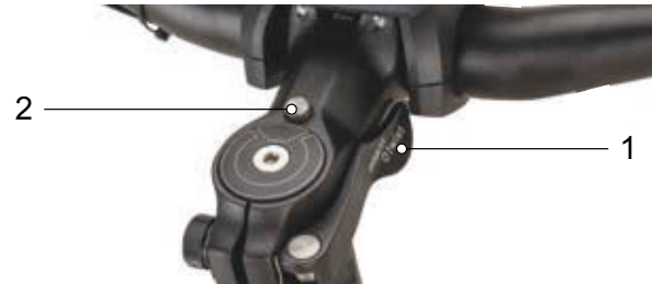
58. ábra: II kivitelű kormányzár a kormányzár-gyorszár (1) gyorskioldójával és reteszelésoldó gombbal (2)
